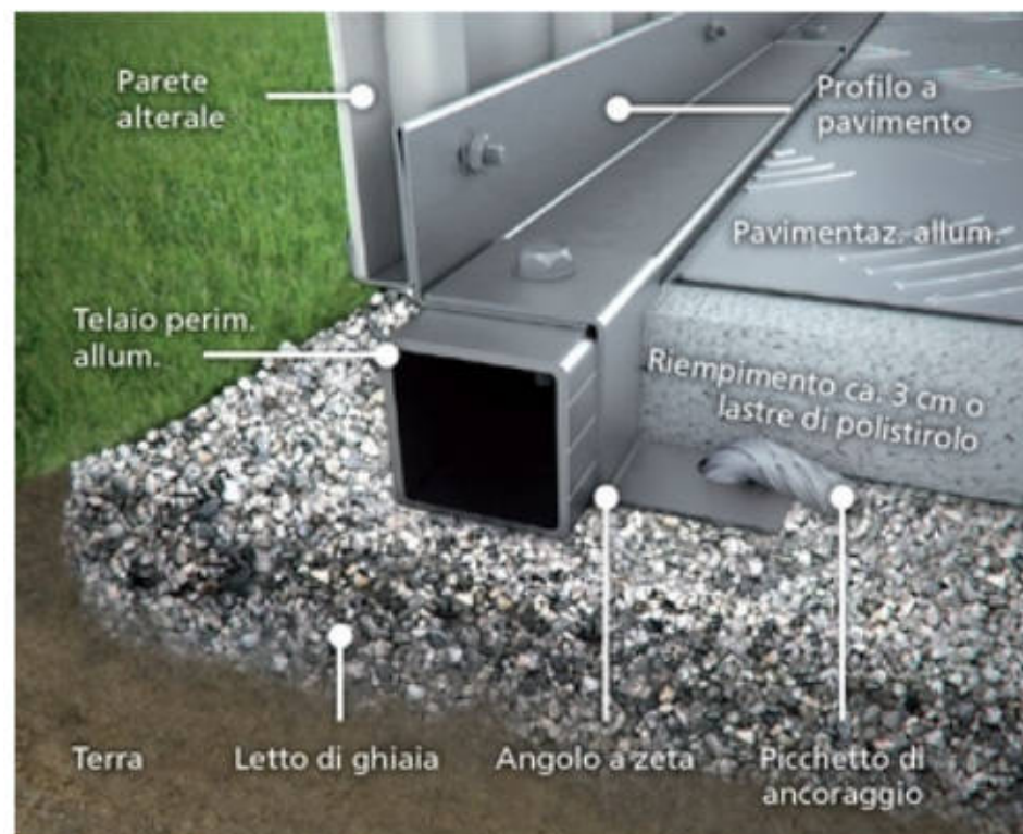
Montaggio su sottofondo con telaio perimetrale (sezione)
